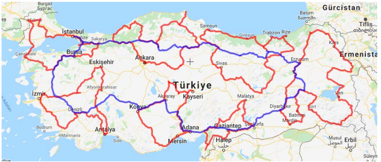
Şekil 15. k=7 bölge için en iyi sonucun bölgeler arası ve bölge içi tur gösterimi
