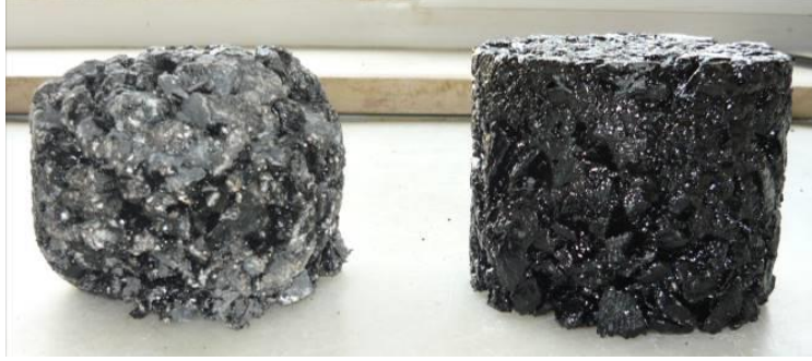
Şekil 8. Cantabro aşınma deneyi öncesinde ve sonrasında numuneler
