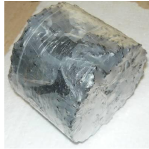
Şekil 4. Boşluk analizleri için parafilm ilke kaplanmış numune
