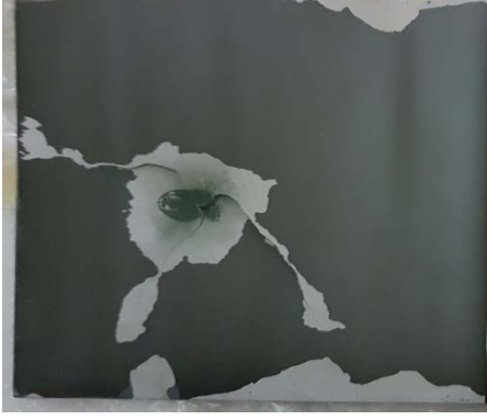
Şekil 9. Al_2O_3 + Cr_2O_3 kaplı plakanın balistik deney sonrasındaki görüntüsü.
