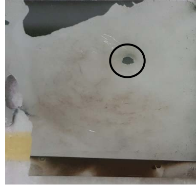
Şekil 3. Cr_2O_3 kaplı plakanın balistik deney sonrasındaki görüntüsü
