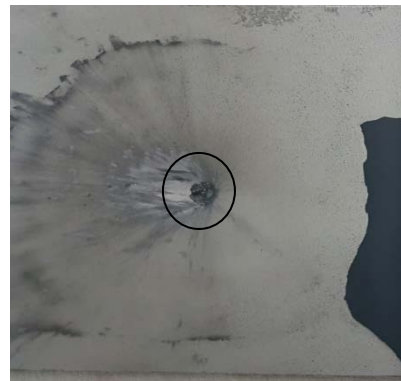
Şekil 5. Al_2O_3 kaplı plakanın balistik deney sonrasındaki görüntüsü
