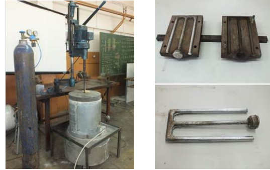
Şekil 6. Karıştırmalı döküm ünitesi ve kalıptan çıkmış numune
