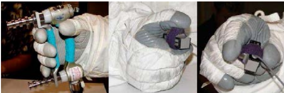
Şekil 7. Kavrama (sol), yanal sıkıştırma (orta), parmak ucu sıkıştırma (sağ) [19]
