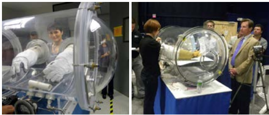
Şekil 6. Dıştan vakumlanmış eldiven testleri [20]
