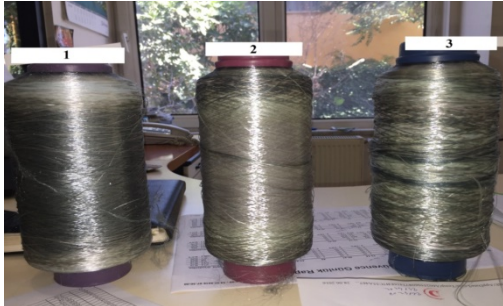
Şekil 3. Plazma ön işleminin boyamaya etkisi (1) Fikse+Plazma işlemi+Boyama, (2) Plazma işlemi+Boyama, (3) Fikse + Boyama (Boyama Laip boyama makinesinde gerçekleştirilmiştir)
