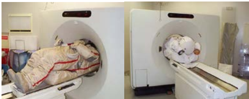
Şekil 21. XCT cihazına yerleştirilen Phantom [41]
