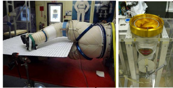
Şekil 4. Pozitif basınç altında bükülme direnci ölçümü (solda), negatif basınç altında bükülme direnci ölçümü (sağda) [8]
