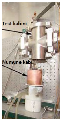
Şekil 23. Elektrik ark testi düzeneği [42]
