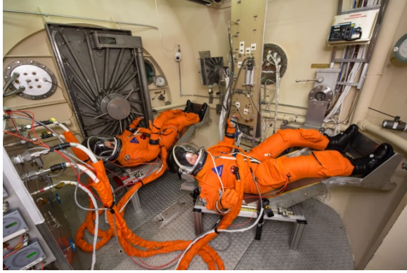
Şekil 3. NASA'da astronot giysileri basınç testlerinin gerçekleştirildiği vakum odası [13]
