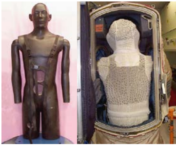
Şekil 20. Phantom (solda), Phantom astronot giysisine yerleştirilirken (sağda) [41]
