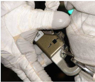
Şekil 11. EMU giysisi D-halkasına bağlanma testi [19]
