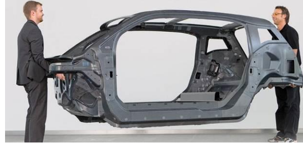
Şekil 9. BMW i3 için geliştirilmiş hafif araç gövdesi [33]
