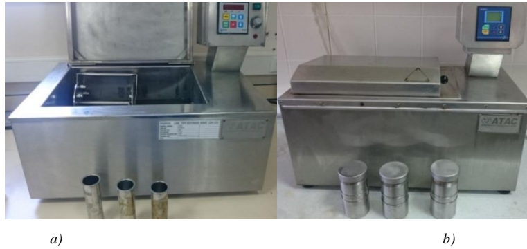
Şekil 2. Yağlı-sulu ısıtma sistemine sahip laboratuvar tipi boyama cihazları a) 150 ml'lik küçük tüplü b) 500 ml'lik büyük tüplü
