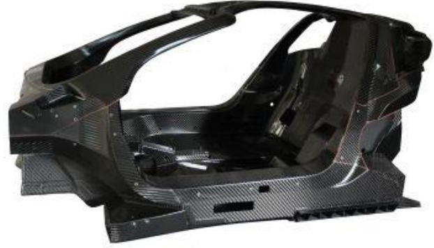
Şekil 8. Mubeo CarboTech ve Volkswagen ortaklığında geliştirilen XL1 dizel hibrid araç gövdesi [31]
