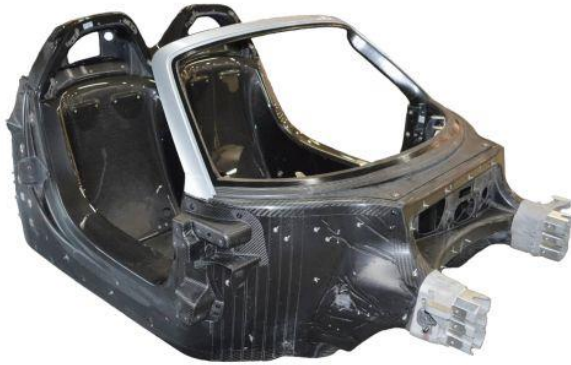
Şekil 7. Mubeo CarboTech'in Porsche 918 Spyder için geliştirdiği hafif araç gövdesi [31]
