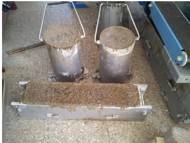
Şekil 4. Polimer betonların dökümü
