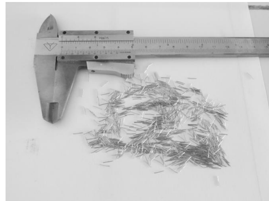
Şekil 2. Çelik liflerin görünümü.
