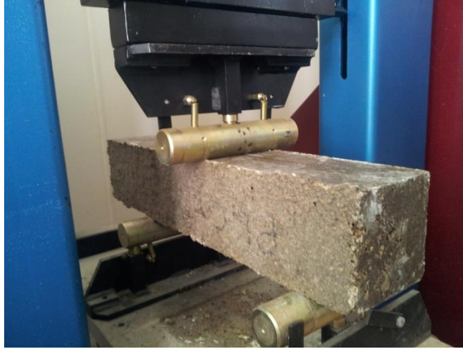
Şekil 7. Numunelerde eğilme dayanımının ölçülmesi
