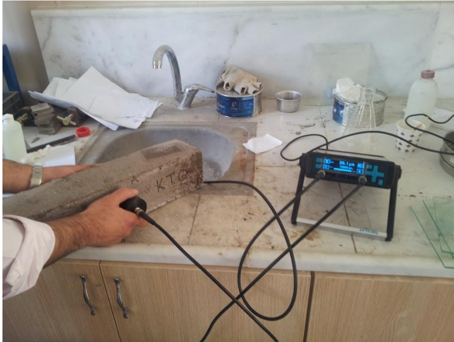
Şekil 8. Numunelerde ultrases geçiş süresinin ölçülmesi.
