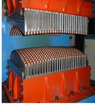
Şekil 6. Derin çekme için MPF (alt ve üst kalıp)
