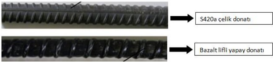
Şekil 2. Çalışmada kullanılan bazalt lifli yapay donatı ve çelik donatı
