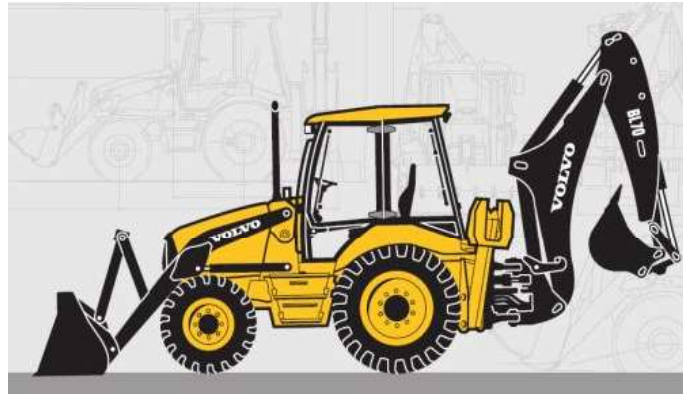
Foto. 3.10. n ve arka kısmına atachment monte edilmiř lastik tekerlekli bir loder
