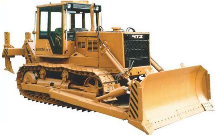
Foto. 3.2. Üzerine aparatlar monte edilerek dozer ve ruter şekline getirilmiş paletli bir traktör
