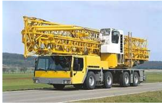
Foto. 3.13. Lastik tekerlekler üzerinde hareket eden kule vinçler
