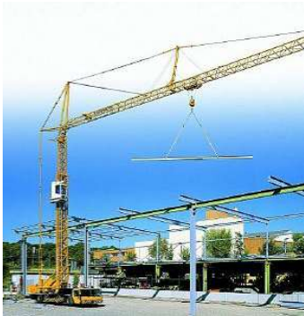
Foto. 3.13. Lastik tekerlekler üzerinde hareket eden kule vinçler
