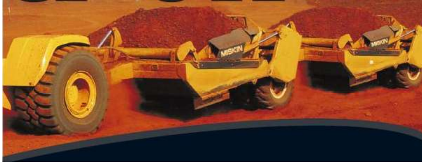
Foto. 3.8. Traktöre bağlı olarak çalışan bir skreyper
