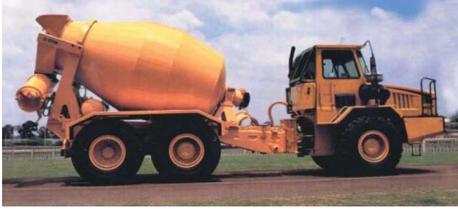
Foto. 3.26. Mobil betoniyer (transmikser)
