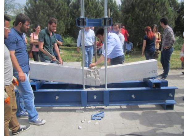
Öğrencilerce Kiriş Üretimi ve Yükleme Deneyi
