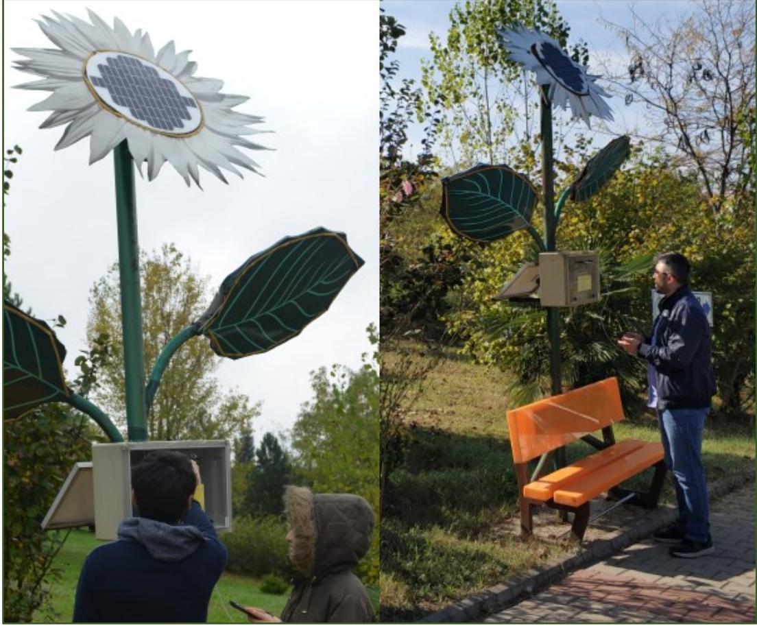
Telefon vb. cihazları şarj eden çiçek tasarımlı güneş enerjisi sistemi Ağdacı Kampüsümüzde kullanımdadır.
