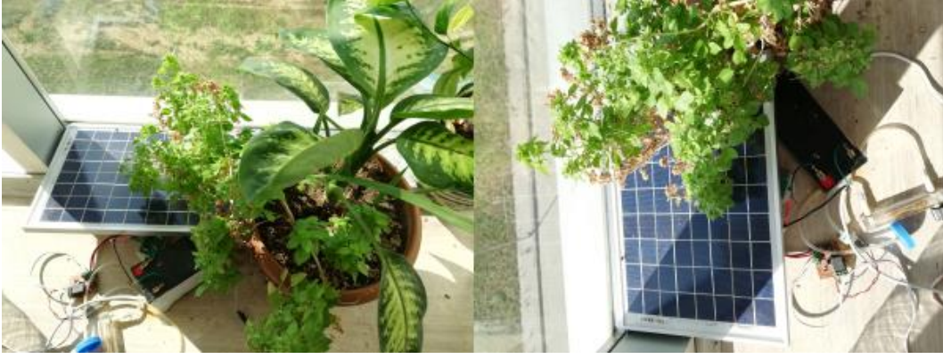
Ofislerde bitkilerin otomatik sulanması için güneş enerjili otomatik sulama sistemi
