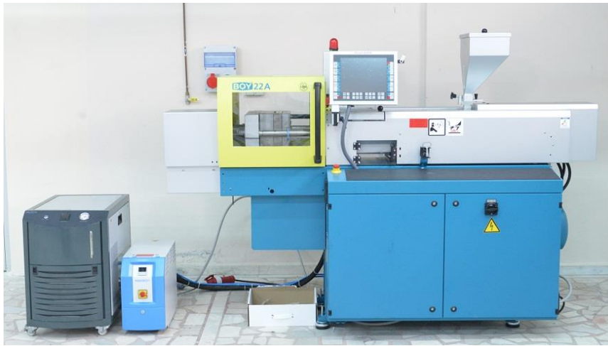
■BOY 22A Plastik Enjeksiyon Makinesi ve Mevcut kalıp kullanılarak elde edilen ürün
