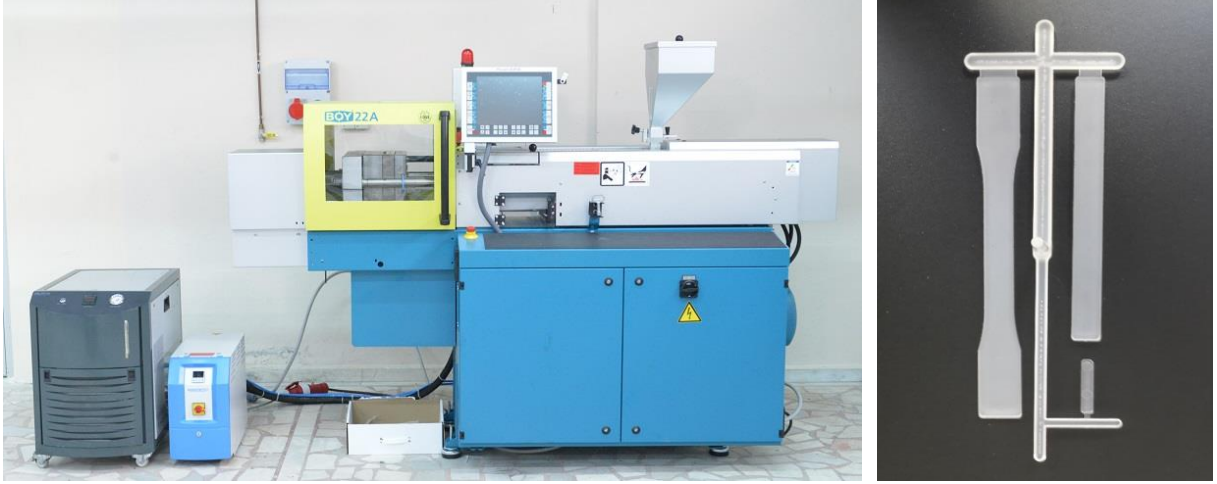
■BOY 22A Plastik Enjeksiyon Makinesi ve Mevcut kalıp kullanılarak elde edilen ürün
