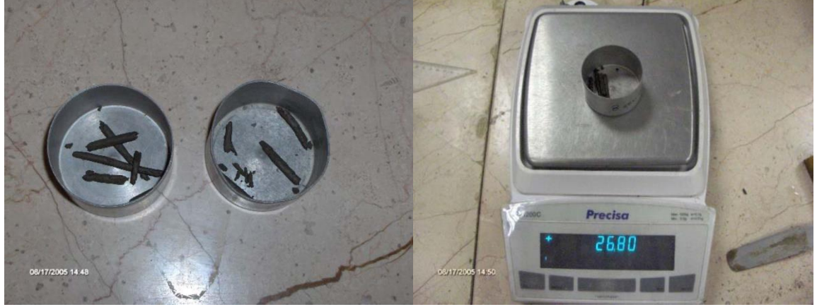
Şekil 4-5. Zemin numunelerinin kaba konulup tartılması
