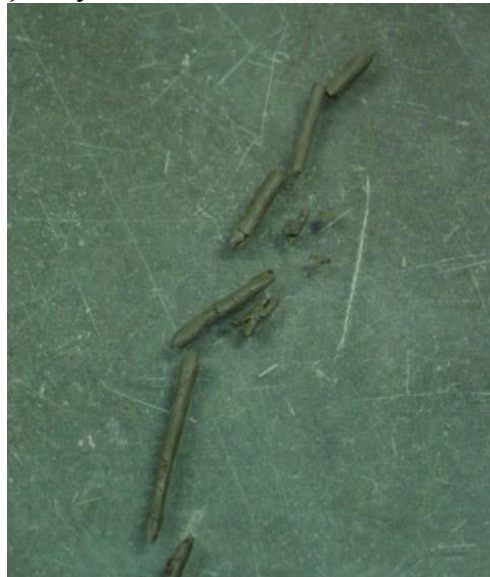
Şekil 3. Zemin numunelerinin 3 mm çubuklar haline geldiğinde çatlamların başlaması
