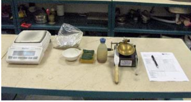
Şekil 2. Casagrande likit limit deneyi için gerekli aletler, cihazın ve oyuk açma bıçağının boyutları
