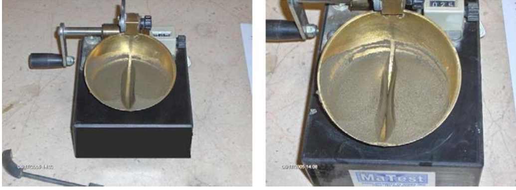
Şekil 10 -11. Yarık açıldıktan ve kapandıktan sonraki durum
