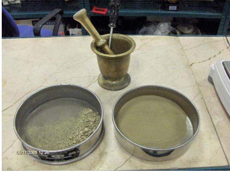
Şekil 3. 40 numaralı elekten elenen zemin numunesi
